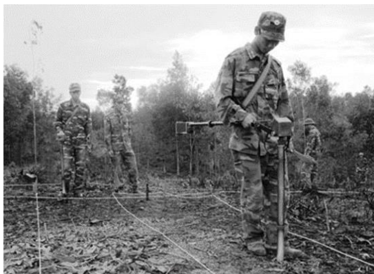
Поиск регистратором магнитных аномалий, модель Vallon EL 1302 D2, США
