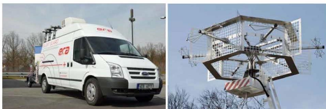
Рисунок 7. Бистатический локатор «Silent Guard»: а – общий вид мобильного варианта; б – антенная система [9]
