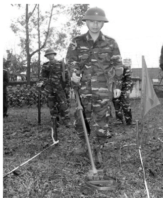
Индукционный прибор (регистратор вихревых токов, модель Vallon VMH3cs, Германия)
